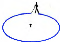
Построение окружности с помощью веревки
