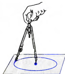
Построение окружности с помощью циркуля
